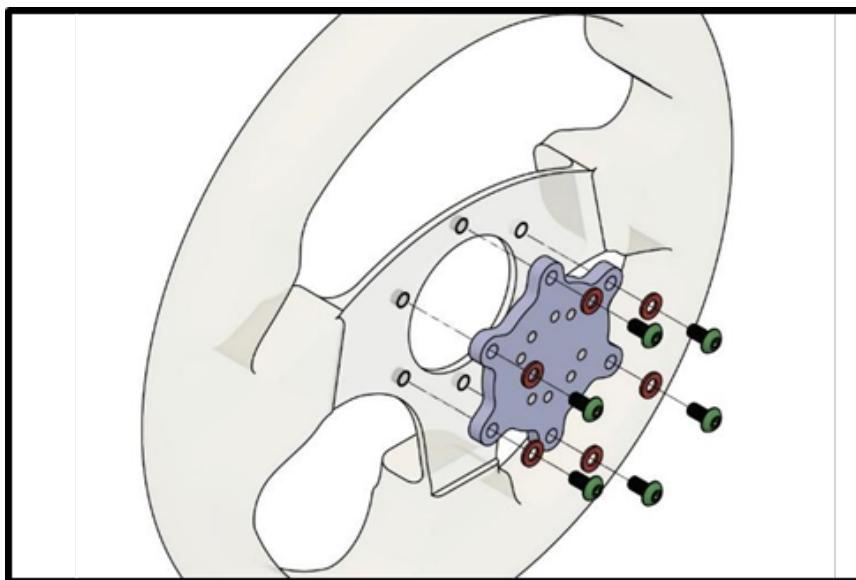
В обоих случаях используйте четыре из прилагаемых винтов M5 длиной 25 мм и 4 шайбы, чтобы прикрепить часть быстросъемного соединения к установленному адаптеру на руль, как показано на рисунке. Примечание. Не прикладывайте чрезмерное усилие, чтобы не повредить резьбу в алюминиевых деталях SQR.
