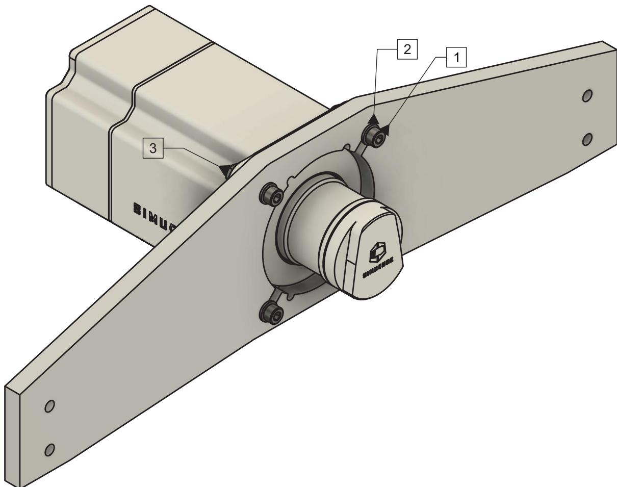
Рисунок 4. Установка Simucube 2 с помощью фронтального кронштейна.
