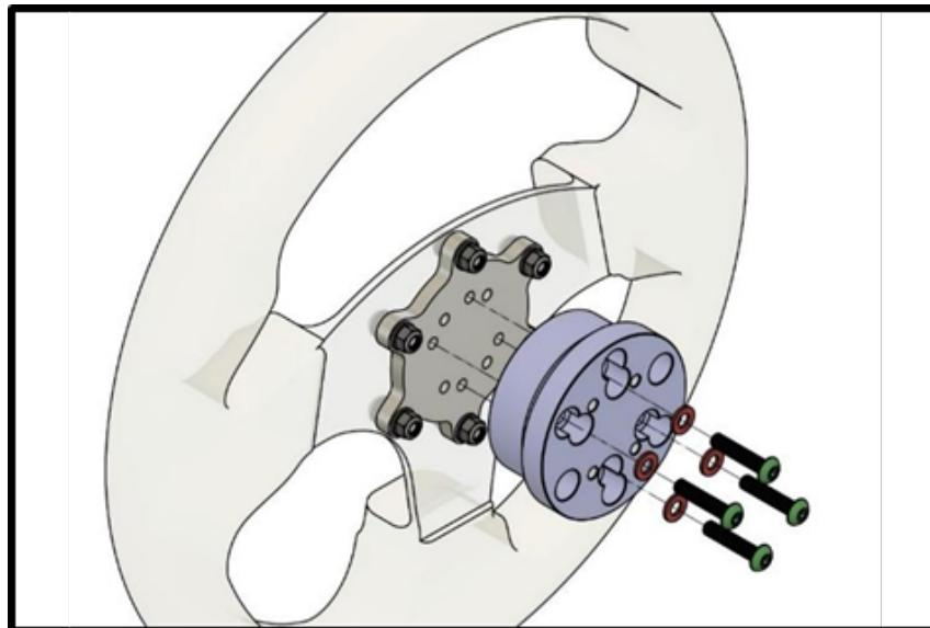
В обоих случаях используйте четыре из прилагаемых винтов M5 длиной 10 мм и 4 шайбы, чтобы прикрепить быстросъемное соединение к установленной проставке на руль, как показано на рисунке. Примечание. Не прикладывайте чрезмерное усилие, чтобы не повредить резьбу в алюминиевых деталях SQR.
