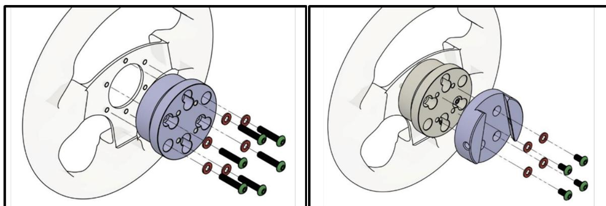
Чтобы установить руль винтами спереди, вам понадобится 3 или 6 винтов M5 и шайбы на каждый винт. Правильная длина этих винтов составляет приблизительно 35-39 мм + толщина вашего руля и рулевой пластины, так как винты крепятся к резьбе на часть быстросъемного соединения.
