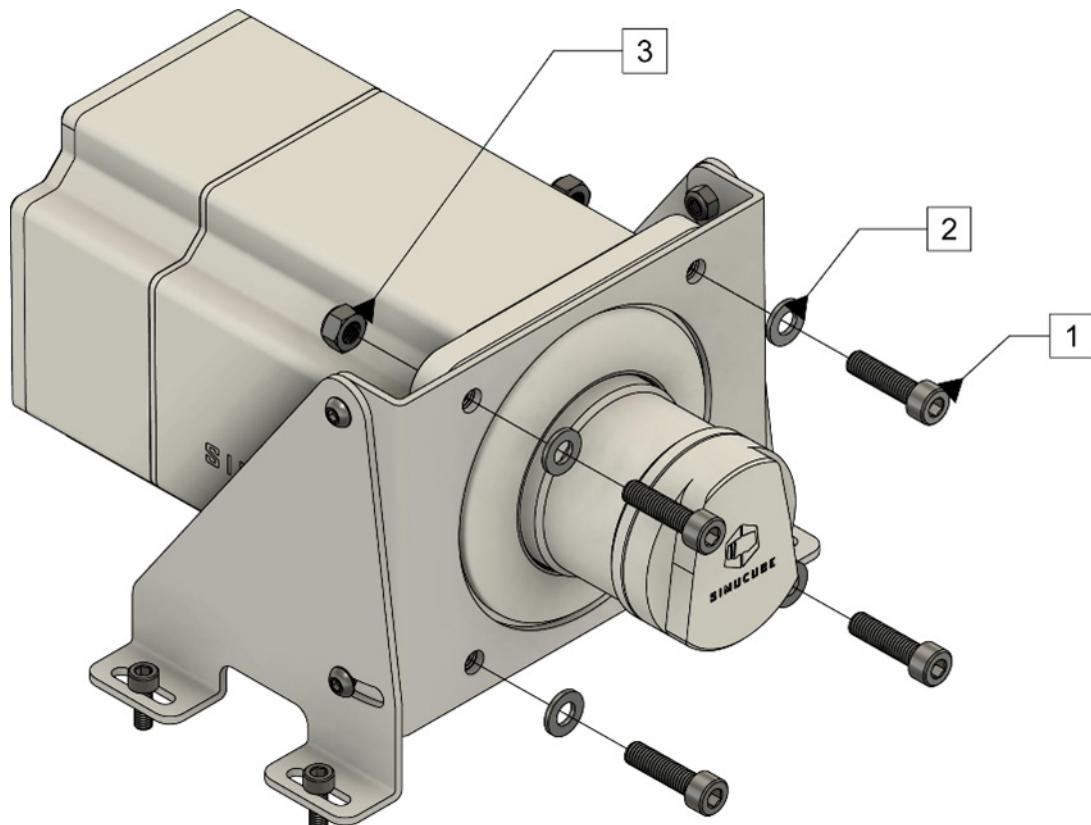
Рисунок 3. Монтаж Simucube 2 с помощью кронштейна с нижним креплением.
