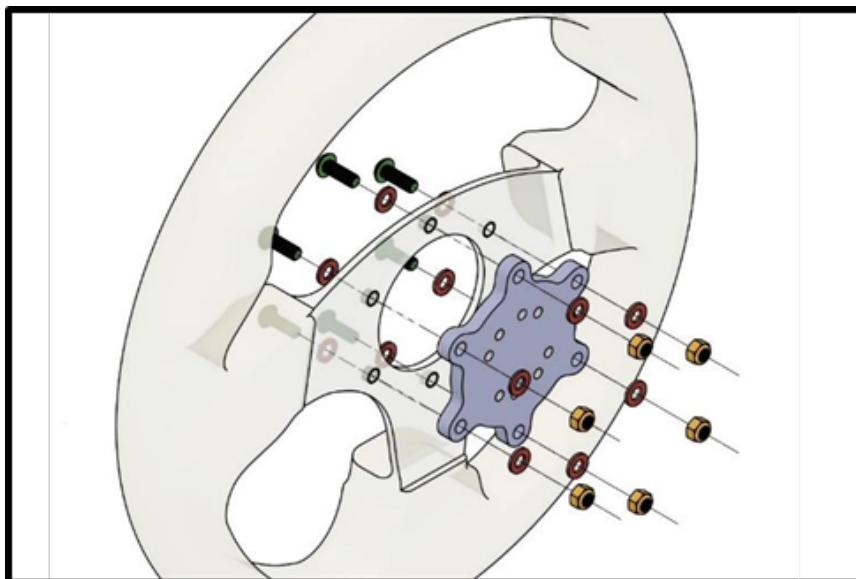
По тому же принципу, устанавливаем руль сзади (если у вас есть резьба в задней части рулевого колеса / рулевой пластины вам понадобятся 6 винтов M5, длина которых зависит от толщины руля и рулевой пластины, и по 1 шайбе на винт. Совместите восемь средних резьбовых отверстий, как показано на рисунке, и прикрепите винты в порядке, показанном на рисунке.
