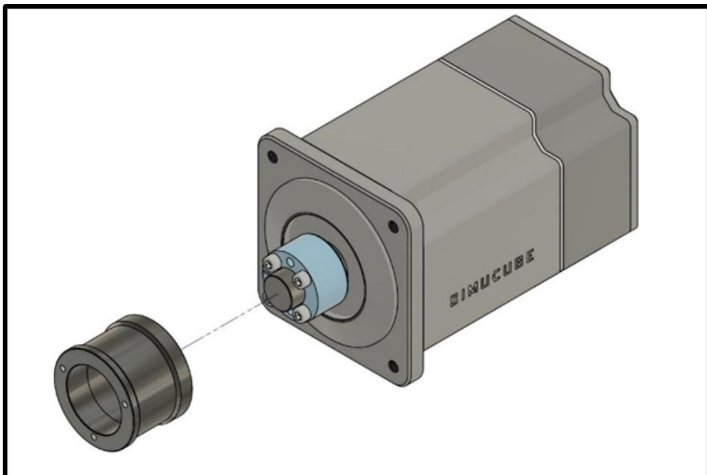
Удалите бумажное полотенце, установите деталь быстросъемной ступицы (часть к базе) и затяните три болта.
