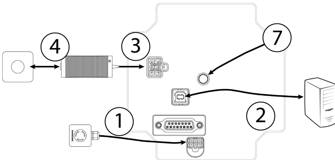
Рисунок 5. Схема подключения Simucube 2 Sport / Pro.
